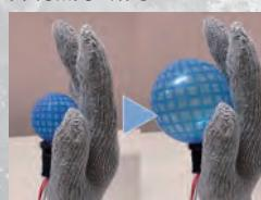
落ちモノゲーム「Catch 実 if you can」は力触覚提示を利用したVRゲームです。プレイヤーはHMDを頭に装着し、手袋型の触覚提示デバイス「パームズ」を手にはめ、VR空間に現れる「実」を手で掴んで並べていきます。プレイヤーが実を掴むと、パームズ内に空気が送り込まれ掌の前で空気圧バルーンが膨らむことで指の動きが制限され、手に何かを掴んでいるという感覚が提示されます。
